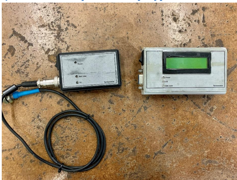
Слика 6.11. – Уређај за бежично мерење температуре („DIY“ варијанта)
